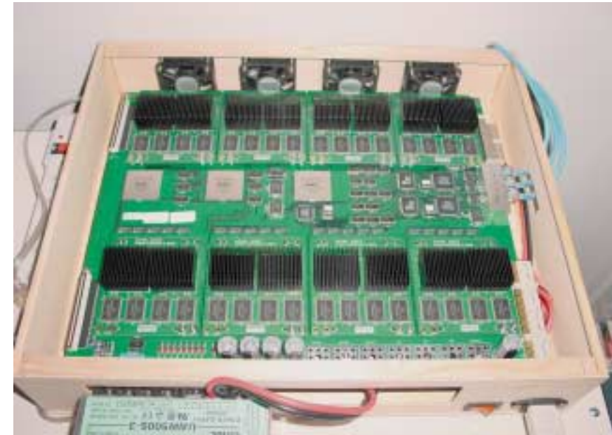
IL COMPUTER GRAPE-6 (GRAVity PipE) è progettato specificamente per gestire l'enorme massa di calcoli necessari per la simulazione delle interazioni dinamiche all'interno di un ammasso stellare denso. GRAPE-6 è assai meno costoso di un supercomputer equivalente, ma è meno flessibile nelle sue applicazioni perché nei chip è integrata parte della logica delle interazioni stellari. Il prototipo qui illustrato è stato usato per le ricerche descritte nell'articolo ed è capace di 500 miliardi di operazioni in virgola mobile al secondo (teraflop). È questa la potenza di calcolo necessaria per seguire la vita di circa 10^4 particelle (stelle e pianeti) in una simulazione a N corpi di un ammasso aperto. La versione attuale di GRAPE-6 è capace di raggiungere 1 teraflop e di gestire circa 10^5 particelle. (La fotografia è stata fornita dagli autori.)
